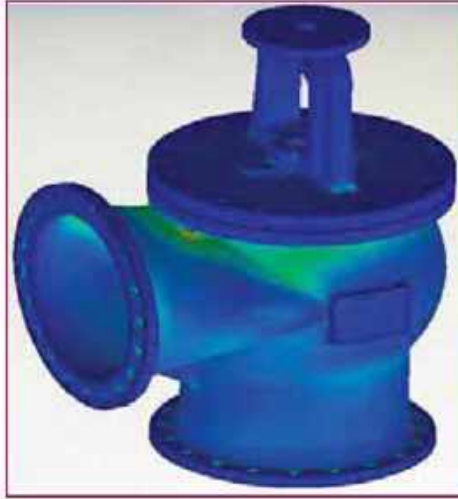
Globe Vana Maksimum Basınçta Stress Analizi
